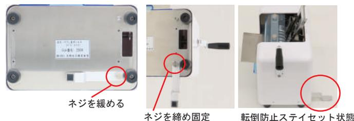
本体底の転倒防止ステイのネジを緩め、90度外側に回し
