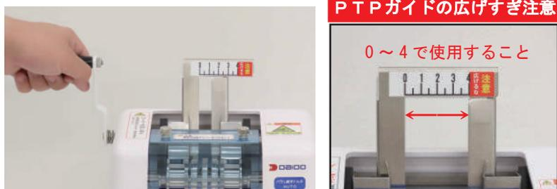
PTP幅調整ハンドルを回しPTPガイドを調整します
