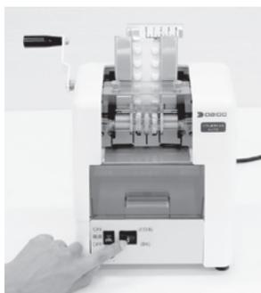
電動タイプは、安全性・耐久性の観点から電源ON状態で3分間で自動停止します。停止しましたら、電源をOFFにして再度電源をONにすると復旧します。
