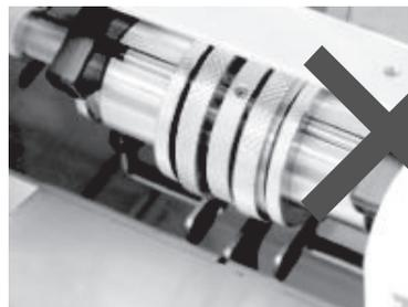
⚠ 前方・後方のPTPシート送りローラーに油分が付着すると
